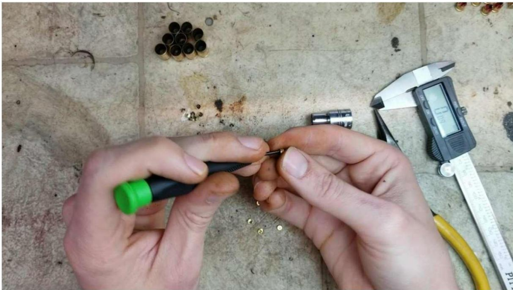
Step 3: Scraping out a primer cup
